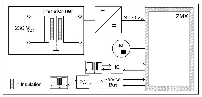
Fig. 8: ZMX<sup>+</sup> Insulation
